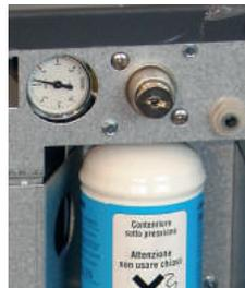
Manomètre intégré pour contrôler la pression du CO<sup>2</sup>.
